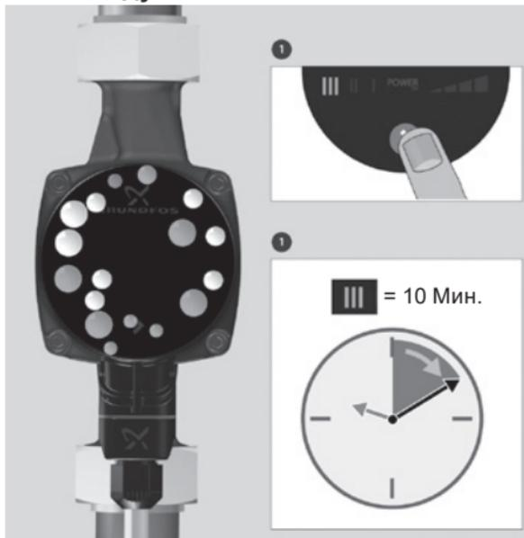
**Рис. 8** Удаление воздуха из насоса
